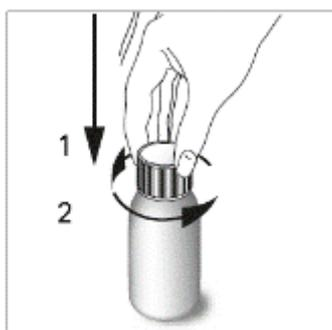
1. Öffnen Sie die Flasche, indem Sie den kindergesicherten Verschluss nach unten drücken und ihn gleichzeitig in Pfeilrichtung drehen.
